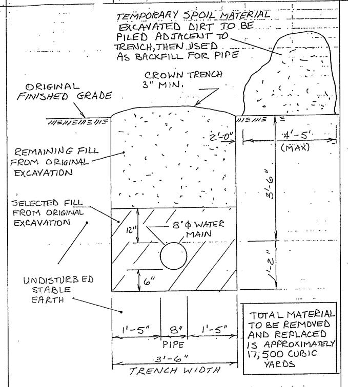
NOTE! NO DIRT SHALL BE HAVLED AWAY, ALL DIRT WILL BE USED AS BACKFILL.
