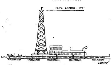
TYPICAL DIESEL POWERED DRILL BARGE
